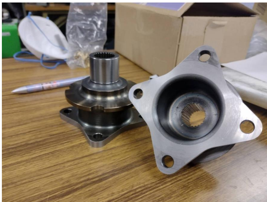
写真 5. 加工をしていただいたスプロケットハブ
