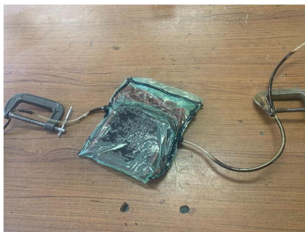
図 3.フラップ積層の様子
